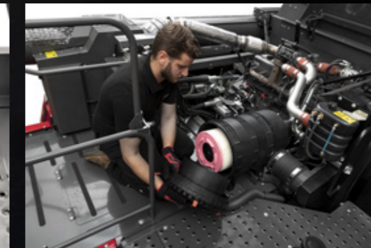
Verificarea și curățarea filtrului de aer
