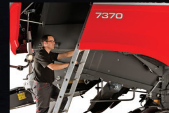
Bezpieczna komora silnika i dostęp do zbiornika na ziarno za pośrednictwem zdejmowanej drabiny
