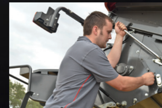
Łatwe przezbrowienie z rozdrabniania na formowanie pokosów
