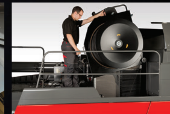
Bezpieczny i łatwy dostęp do czyszczenia chłodnicy
