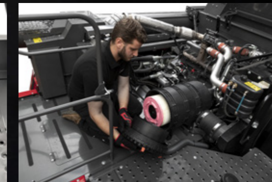
Controllo e pulizia del filtro dell'aria
