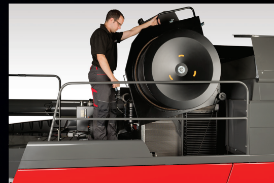
Accès aisé et sécurisé pour le nettoyage des radiateurs
