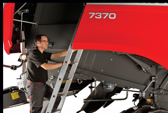
Accès sûr au compartiment moteur et à la trémie à grain avec échelle amovible
