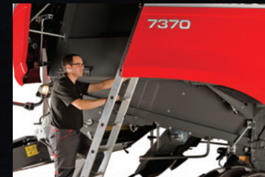
Turvallinen pääsy moottoritilaan ja viljasäiliöön irrotettavien tikkaiden avulla
