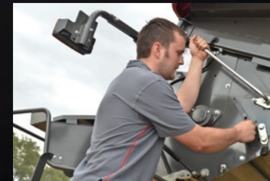
Yksinkertainen vaihto silppuamisesta karhelle ajoon paalausta varten
