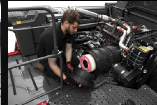
Ilmanpuhdistajan tarkastus ja puhdistus
