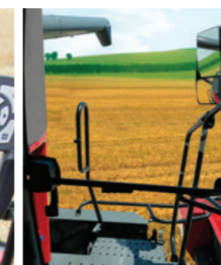
Vista completa del sinfín de descarga sin tener que inclinarse hacia delante
