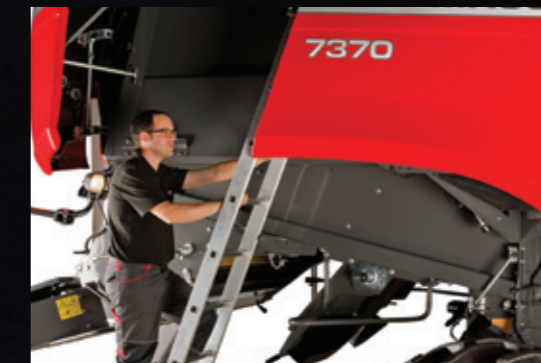
Acceso seguro al compartimento del motor y a la tolva de grano mediante la escalera extraíble
