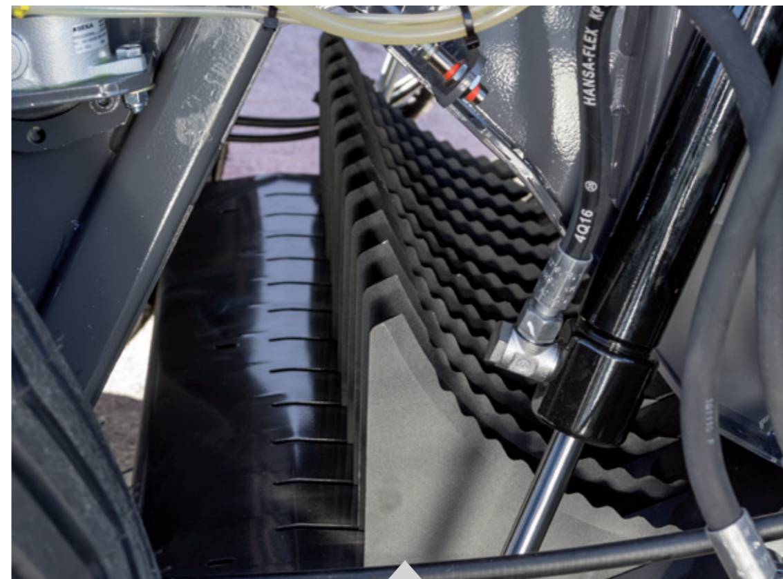
System tnący Xtracut 13 tnie materiał na odcinki 90 mm
