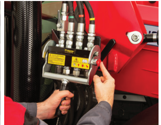
Hydraulische und elektrische Verbindungen trennen
