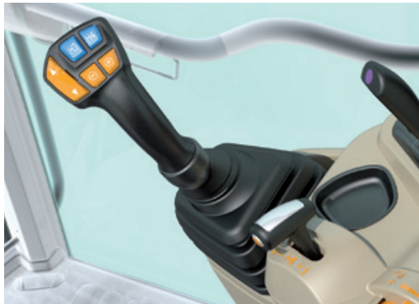
Kabinenoption Essential mit mechanischem Multifunktions-Joystick
