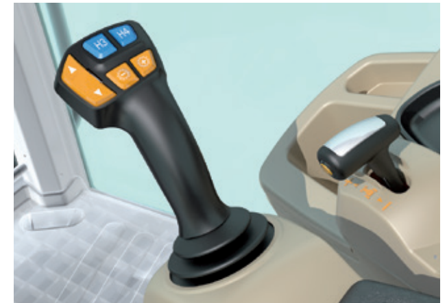
MF 5700 S-Kabinenoption Essential mit elektrischem Frontlader-Multifunktions-Joystick
