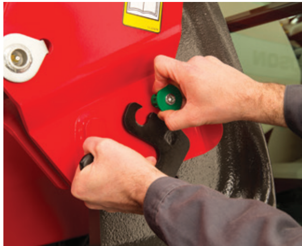
Arretierung lösen, dann Bolzen drehen und ziehen
