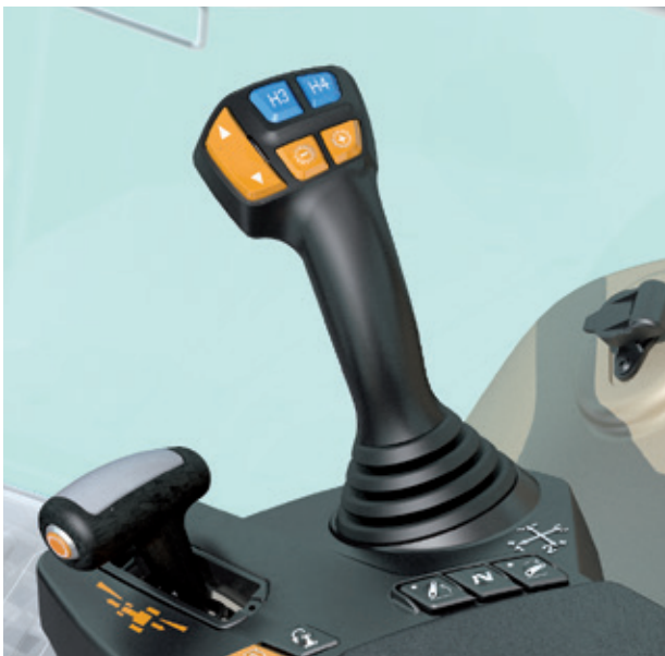
Kabinenoption Efficient mit elektrischem Multifunktions-Joystick und Armlehne
