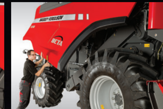
Einteilige Seitenabdeckungen mit Beleuchtung ermöglichen einen schnellen Zugang für Wartungsarbeiten
