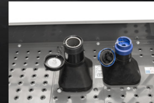
Einfaches Betanken - beide Tankstutzen sind leicht zugänglich nebeneinander angeordnet
