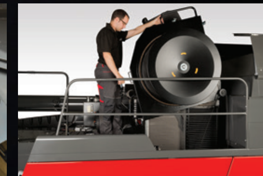
Sicherer und einfacher Zugang zur Reinigung des Kühlers
