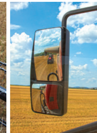
Optimaler, sicherer Überblick dank zweigeteilter Spiegel
