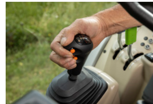
▲ Ny gearstang med bowdenkabel til jævn drift.
