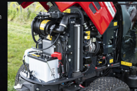
Udformning af motorhjem og foraksel sikrer nem adgang til motoren.
