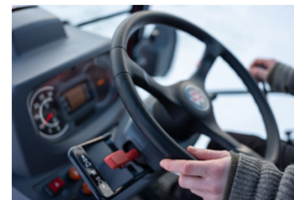
Mekanisk transmission med power shuttle på MF 1700 M - 12Fx12R hastigheder for maksimal komfort til alle opgaver.
