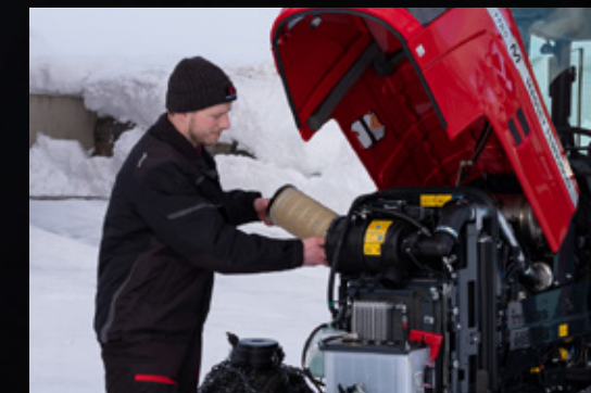
Den velproportionerede kølerpakke er let tilgængelig, nem at rengøre og vedligeholde. Motorens luftfilter er også meget let tilgængeligt og nemt at rengøre.
