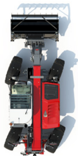
KRABBESTYRING – til effektiv fyldning og planering samt til arbejde langs mure og under snævre forhold.
