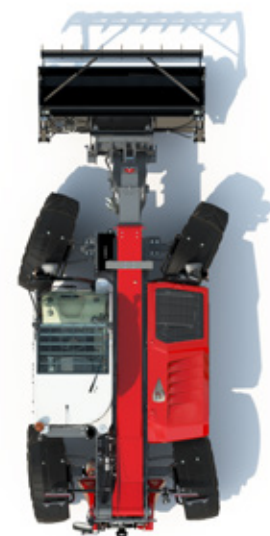
HALV-KRABBESTYRING indstiller vinkel for baghjul – praktisk til opgaver som f.eks. ensilage eller rengøring af laden.
